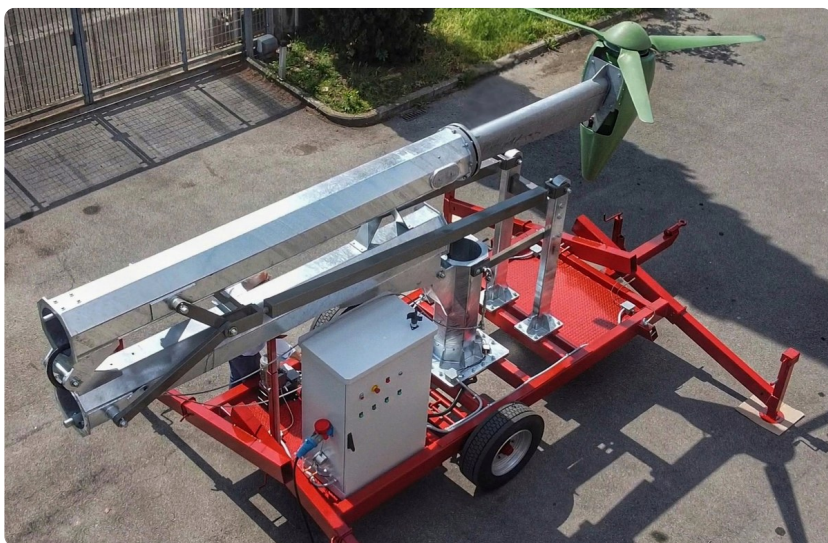
Mobile Antibrina 3-22-C: Turm auf dem Fahrgestell zusammengelegt.
